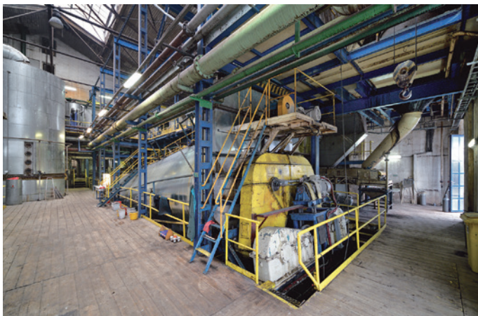
Litovel, horizontální Žlabový extraktor DdS. Foto Roman Polášek, 2023 Extraktor řepy KDP, ZVÚ. Schéma Radek Míšanec, 2025
