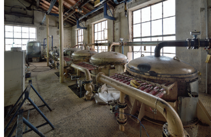
Litovel, část epurační linky, filtry SPOMA. Foto Roman Polášek, 2023
