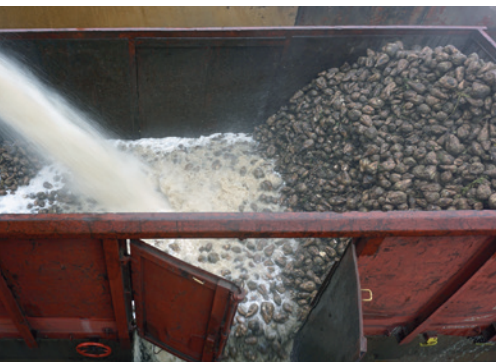
Hrušovany nad Jevišovkou, plavení řepy z vagonů pomocí Elfy. Foto Daniel Froněk, 2023
