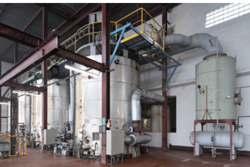
Litovel, část zrníků na varné cukrovaru. Foto Roman Polášek, 2023
