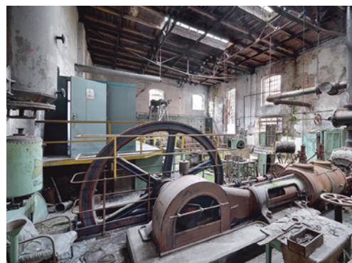
Bedihošť, ležatý parní stroj s ventilovým rozvodem LENTZ (První brněnská strojírenská společnost, 1927) v tandemovém uspořádání s parní vývěvou. Foto Tomáš Flimel, 1989; Roman Polášek, 2023
