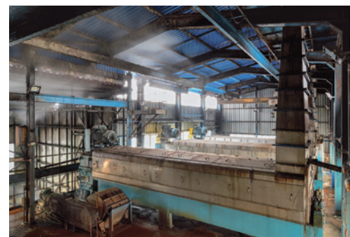
Opava-Vávrovice, řízkolisová stanice, zahraniční řízkolisý typ Stord a Babbini. Foto Roman Polášek, 2023
