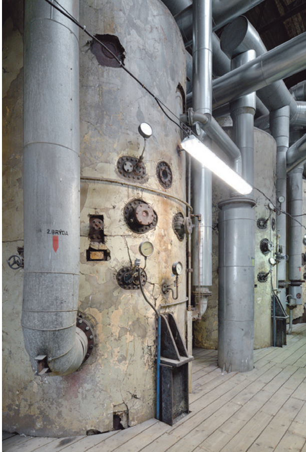
Litovel, tělesa odparky systému Vinclick-Turek od firmy Brand & L'huillier z roku 1921. Foto Roman Polášek, 2023
