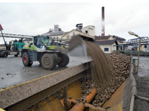
Litovel, plnění násypky na začátku čištění řepy. Foto Roman Polášek, 2023
