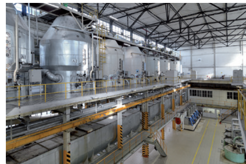
Opava-Vávrovice, část zrníků pro B produkt (repase Maďarsko) a vpravo odparka (ZVÚ). Foto Roman Polášek, 2023
