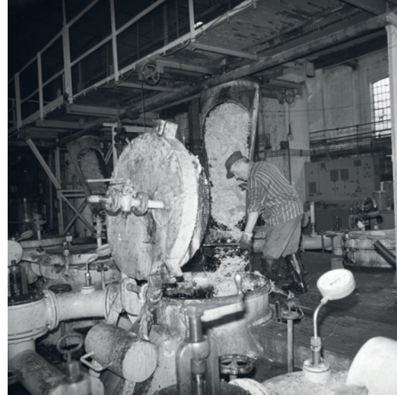
Bedihošť, plnění Robertova difuzéru. Foto Milan Začal, 1986. SOKA Prostějov, Sběrka obrazového a fotografického materiálu SOKA Prostějov, sign. N89_3_1, příř. č. 17742
