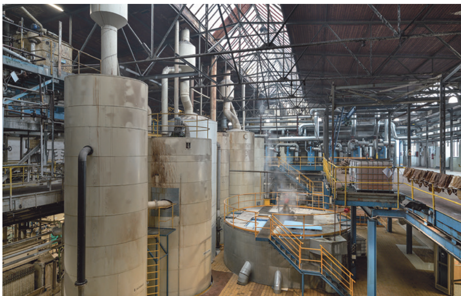
Opava-Vávrovice, část surovarny s nádobami saturace a dekantéru. Foto Roman Polášek, 2023
